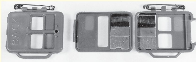
Figur 9. Et filmdosemeter. Filmen er innkapslet i en liten plastholder med små, tynne absorpsjonsplater av bly, kadmium og plast. I tillegg er det et åpent vindu der den minst gjennomtrengende strålingen slipper inn til filmen. Svertingen bak de ulike platene avhenger av strålingens energi og om det er \beta - eller \gamma -stråling.
