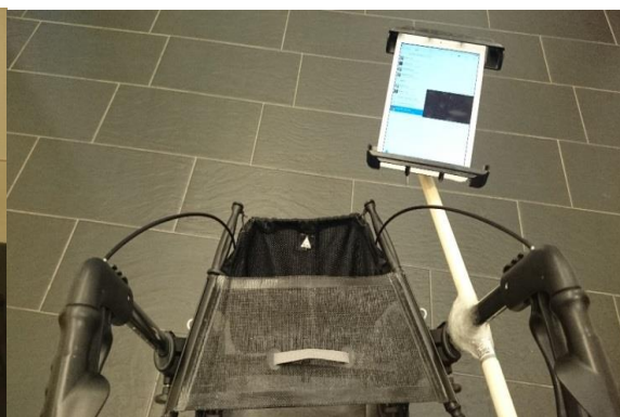
Figur 10: iPad festet til rullator med ekstern søyle
