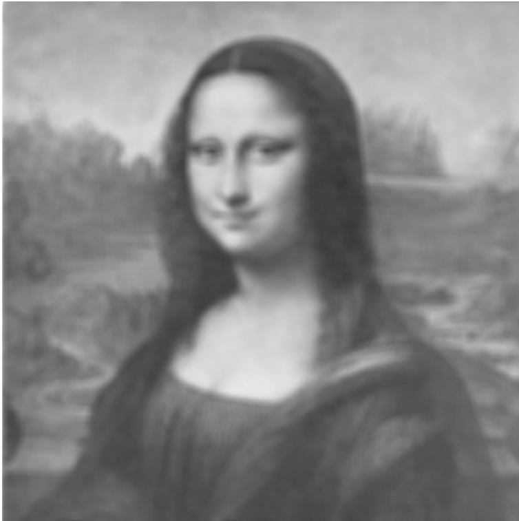
Filtrert med 9x9-middelverdifilter
