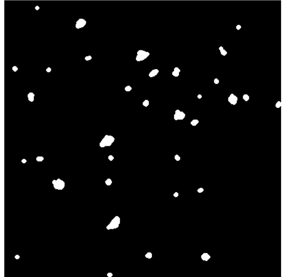
Åpning med et (7x7) sirkulært strukturelement
