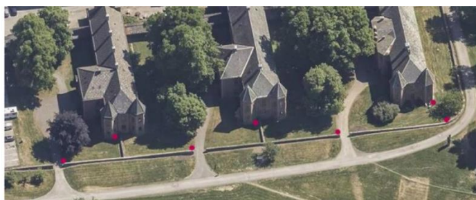
Figur 8 – Plassering av rystelsesmålere (røde punkter) på muren og på bygningene. 4 stk målere på muren og 3 stk målere på bygningene.
