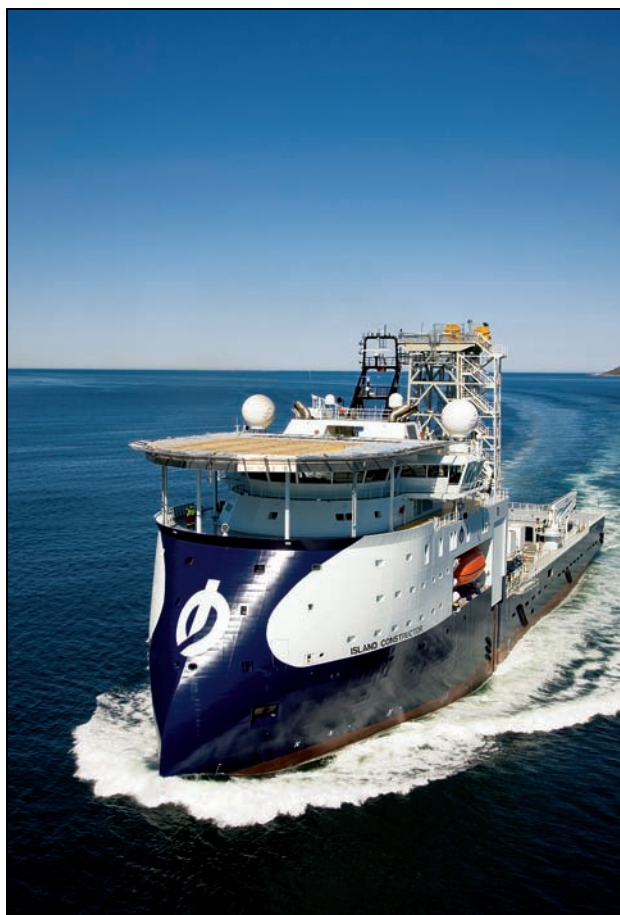
Figur 2.1 Det nye fartøykonseptet ULSTEIN X-BOW®.
