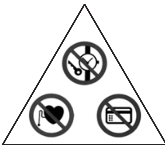
Figur 6-1 Dører som fører inn til MR-laboratoriet skal merkes med fareskilt.
