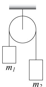
La oss se hva som skjer når systemet slippes. La kraften fra snoren på lodd 1 være  $T_1$  og kraften fra snoren på lodd 2 være  $T_2$ . Siden trinsen er masseløs er  $T_1 = T_2 = T$ . Massesentersatsen for hvert av loddene gir da:
