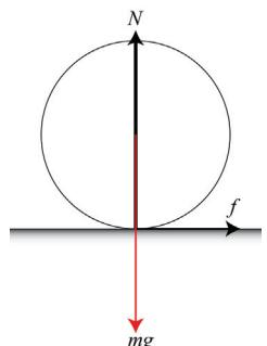
Så lenge hjulet glir mot underlaget er det dynamisk friksjon, slik at friksjonskraften er gitt som  $f = \mu N = \mu mg$
