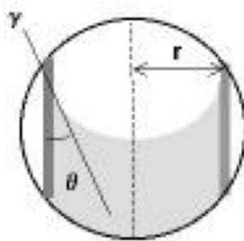
Dette skjer fordi kontaktvinkelen gjør at vannoverflaten inne i røret blir krum. Hvis kontaktvinkelen mellom glasset og vannet er  $\theta$ , må trykket i vannet like under overflaten,  $p_h$ , være lavere enn lufttrykket,  $p_0$ . Krumningsradien  $R$  er gitt av kontaktvinkelen og radien til glassrøret,  $r$ . Da gir av Young-Laplace-likningen:
