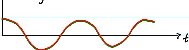
Modus  $\omega_2$ :  $\omega_2 = \sqrt{\frac{3k}{m}}$ ,  $K - \omega_2^2 M = \begin{bmatrix} -k & -k \\ -k & -k \end{bmatrix}, \quad (K - \omega_2^2 M)a = 0 \Rightarrow -k \begin{bmatrix} 1 & 1 \\ 1 & 1 \end{bmatrix} \begin{bmatrix} a_1 \\ a_2 \end{bmatrix} = 0$
