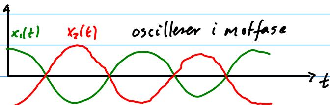
Generell løsning:  $x(t) = A_1 \begin{bmatrix} 1 \\ 1 \end{bmatrix} \cos(\omega_1 t - \delta_1) + A_2 \begin{bmatrix} 1 \\ -1 \end{bmatrix} \cos(\omega_2 t - \delta_2)$ ,  $\omega_2 = \sqrt{3}\omega_1$
