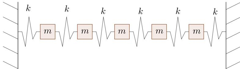
Figur 1: Et system med fem masser mellom to veggger, skilt av fjærer. Alle massene og fjærkonstantene er like.
