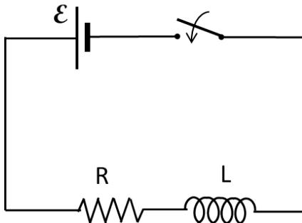
Figuren viser en krets der bryteren lukkes ved tiden  $t = 0$ . Her er  $R = 2\text{ k}\Omega$ ,  $L = 5\text{ mH}$ , mens batteriet har en elektromotorisk spenning på 12 V, og indre resistans 10  $\Omega$ .
