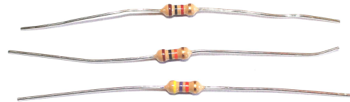
Figur 2.40: Tre motstander. Fargene på ringene angir resistansen.
