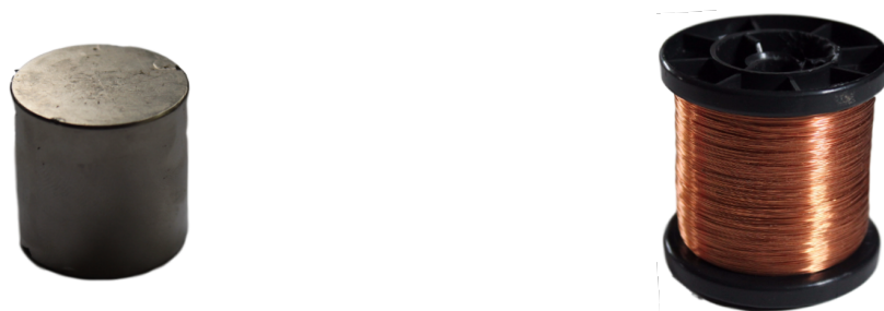
Figur 3.21: En cylindrisk permanentmagnet vil gi opphav til det samme \mathbf{B} -feltet som en cylindrisk, tettviklet spole. Hvis vi beskriver magnetiseringen til en 1 cm høy neodym-magnet i form av en effektiv (bunden) flatestrøm på overflaten, vil det gå 10000 A rundt magneten!
