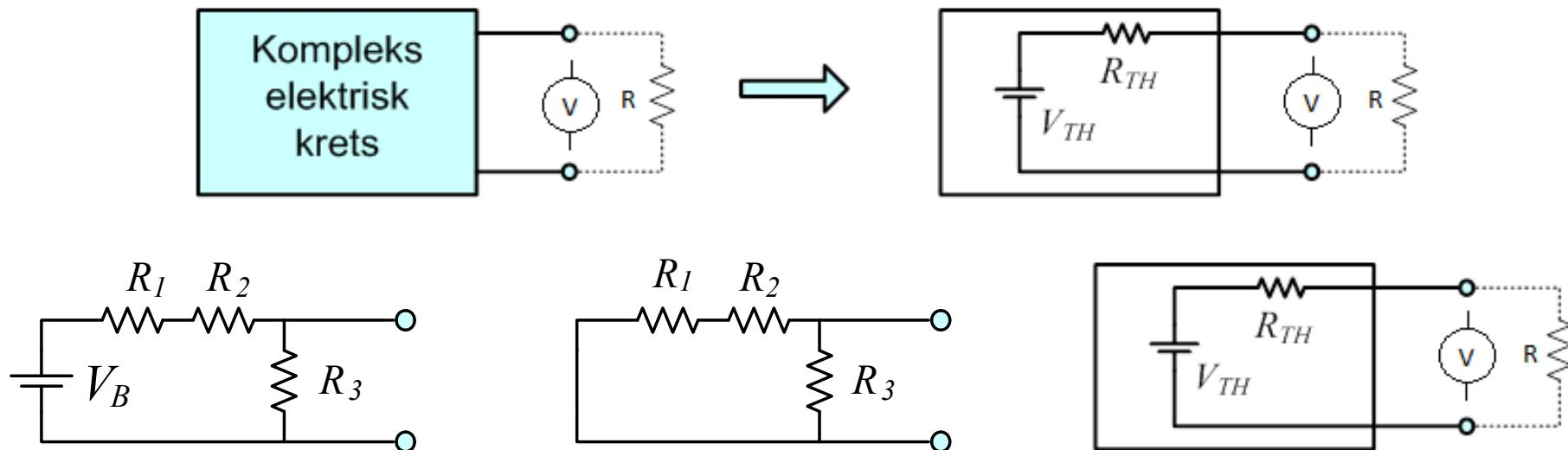
$$V_{TH} = \frac{R_3}{R_1 + R_2 + R_3} \cdot V_B$$
