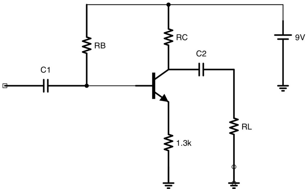
**2a)** Vi ønsker en hvilestrøm på kollektor på 1mA, velg passende arbeidspunkt og beregn RC.
