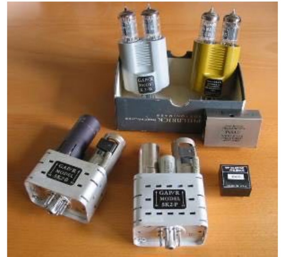
Historiske OpAmps fra Philbrick Bygget opp av "radiatorer" – hvert "rør" inneholder 2 forsterkere (2 stk. trioder)
