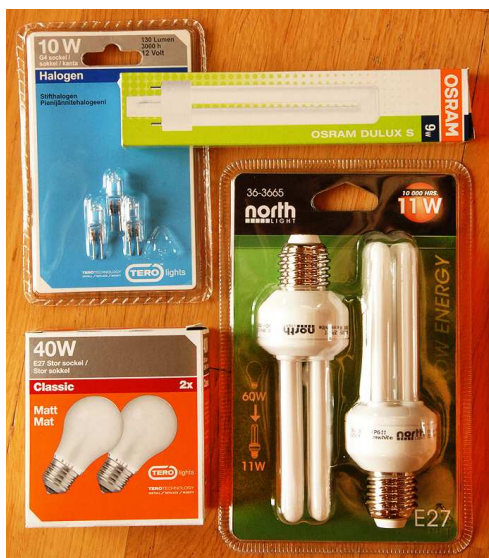
Figur 10.4: Eksempler på dagens lyspærer (til venstre). Effekt, lysstrøm, levetid i timer og spenning er angitt: 10 W halogenpærer (130 lumen, 3000 t, 12 V), 40 W Classic (300 lumen, 2500 t, 240 V), 11 W sparepære (“= 60 W”) (650 lumen, 10000 t, 240 V), og 9 W lysstoffrør (“= 60W”) (600 lumen, ukjent levetid, 240 V anlegg). Til høyre: Bilde av organisk lys-emitterende dioder (oled-panel) sammen med noen vanligere lyskilder. Bildet er hentet fra en artikkel om oled skrevet av Gary Boas i Photonics spectra februar 2010.
