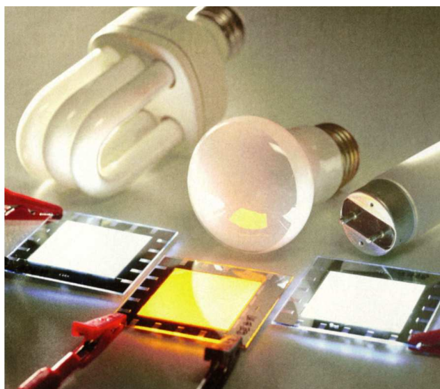
Figur 10.4: Eksempler på dagens lyspærer (til venstre). Effekt, lysstrøm, levetid i timer og spenning er angitt: 10 W halogenpærer (130 lumen, 3000 t, 12 V), 40 W Classic (300 lumen, 2500 t, 240 V), 11 W sparepære (“= 60 W”) (650 lumen, 10000 t, 240 V), og 9 W lysstoffrør (“= 60W”) (600 lumen, ukjent levetid, 240 V anlegg). Til høyre: Bilde av organisk lys-emitterende dioder (oled-panel) sammen med noen vanligere lyskilder. Bildet er hentet fra en artikkel om oled skrevet av Gary Boas i Photonics spectra februar 2010.
