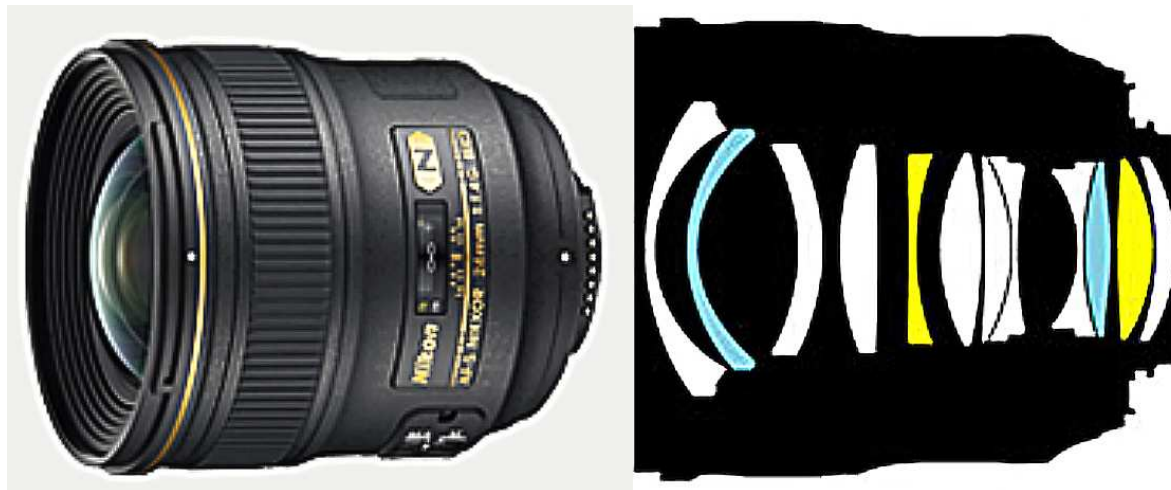
Figur 11.6: Eksempel på et moderne objektiv for fotografi: AF Nikkor 28 mm f/1.4 GED objektiv. I stedet for én enkel tynn linse, slik vi tenker oss et objektiv i vår gjennomgang av geometrisk optikk, har Nikkon-objektivet 12 linser som spiller sammen som én. De fleste enkeltlinsene har sfæriske overflater, men to (de blå) har ikke-sfæriske overflater. To linser (de gule) er laget av ekstra dispersivt glass, det vil si at brytningsindeksen har en annerledes variasjon med bølgelengden enn det som er mest vanlig i andre glasstyper. Illustrasjonene er hentet fra websidene til Nikon 6. april 2013.
