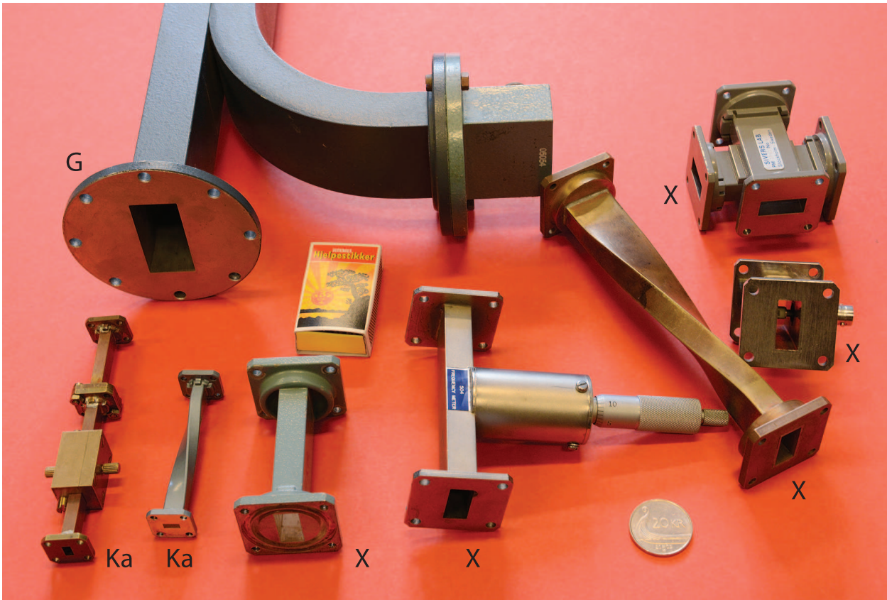
Figur 15.3: Fotografi av en del mikrobølgekomponenter der bølgeledere inngår. Utstyrekompone- nenter for tre ulike frekvensbånd er tatt med.)
