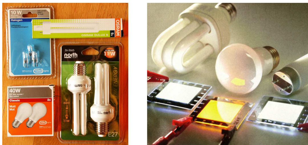
Figur 10.4: Eksempler på dagens lyspærer (til venstre). Effekt, lysstrøm, levetid i timer og spenning er angitt: 10 W halogenpærer (130 lumen, 3000 t, 12 V), 40 W Classic (300 lumen, 2500 t, 240 V), 11 W sparepære (“= 60 W”) (650 lumen, 10000 t, 240 V), og 9 W lysstoffrør (“= 60W”) (600 lumen, ukjent levetid, 240 V anlegg). Til høyre: Bilde av organisk lys-emitterende dioder (oled-panel) sammen med noen vanligere lyskilder. Bildet er hentet fra en artikkel om oled skrevet av Gary Boas i Photonics spectra februar 2010.
