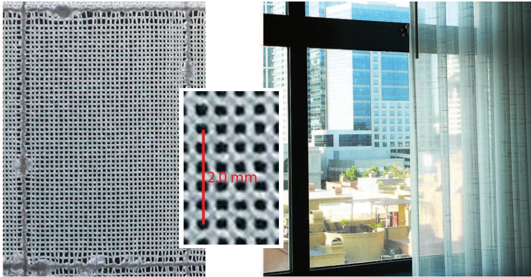
Figur 12.26: Bildet fra et lett gardin som det var mulig å se gjennom. Detaljer viser hvordan fibrene i gardinet lå i forhold til hverandre. Staven i midtre del er opprinnelig 2.0 mm lang.
