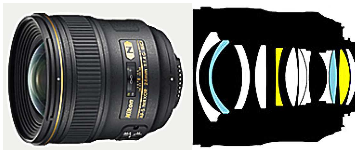
Figur 11.6: Eksempel på et moderne objektiv for fotografi: AF Nikkor 28 mm f/1.4 GED objektiv. I stedet for én enkel tynn linse, slik vi tenker oss et objektiv i vår gjennomgang av geometrisk optikk, har Nikon-objektivet 12 linser som spiller sammen som én. De fleste enkeltlinserne har sfæriske overflater, men to (de blå) har ikke-sfæriske overflater. To linser (de gule) er laget av ekstra dispersivt glass, det vil si at brytningsindeksen har en annerledes variasjon med bølgelengden enn det som er mest vanlig i andre glasstyper. Illustrasjonene er hentet fra websidene til Nikon 6. april 2013.
