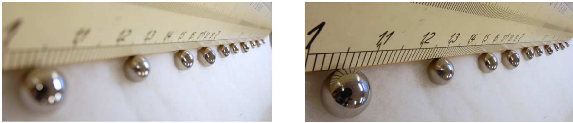
Figur 11.24: Når et lysende punkt i et objekt avbildes av en linse, vil det avbildes omtrent som et punkt i det aktuelle fokalplanet. Dersom vi skal avbilde flere objekter som ikke har samme avstand til linsen, finnes det ikke ett fokalplan for bildene som dannes. Da vil lysende punkter i objekter som har en annen avstand til linsen enn det vi har fokusert på, bli avbildet som sirkulære skiver, og bildet blir “uskarpt”. Ved å redusere åpningen til blenderen vil uskarpheten bli redusert (vinkel \phi_2 er mindre enn vinkel \phi_1 i figur 11.23), og vi sier at vi har fått større dybdeskarphet. I venstre fotografi er det brukt et objektiv med blendertall 3.5 og lukkertid 1/20 s, i høyre foto er det brukt samme objektiv og fokusering, men nå med blendertall 22 og lukkertid 1.6 s.
