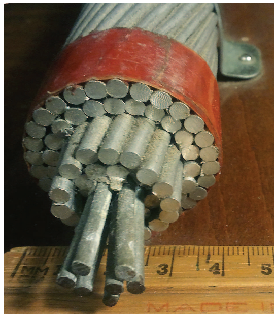
Figur 15.7: Tverrsnitt i en type leder som anvendes i kraftledninger som henger mellom store master over store deler av landet. (Bildet er tatt fra Wikipedia under oppslagsordet: “Overhead power lines” mai 2014.)
