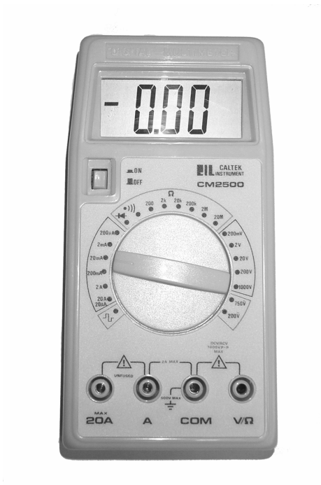
Figur 3: Frontsiden av et digitalt multimeter uten automatisk områdevalg. På dette instrumentet må en stille inn både funksjon og måleområde.
