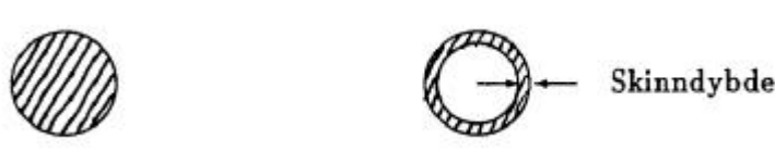
Figur 1: Effektivt tverrsnitt for den elektriske strømmen er avhengig av tykkelsen på kabelen i forhold til den såkalte “skinndybden”. For likestrøm og lave frekvenser, vil hele tverrsnittet av kabelen benyttes (a), mens for høyere frekvenser vil bare en ytre del av kabelen lede strøm (b).
