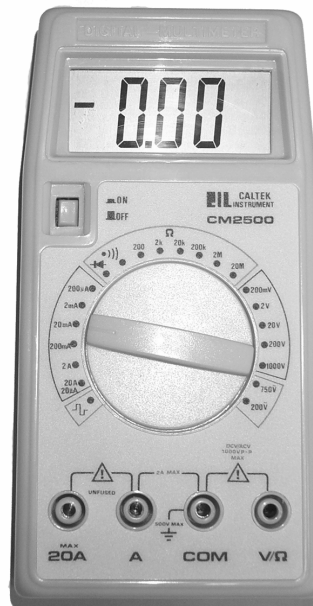
Figur 2: Frontsiden av et digitalt multimeter uten automatisk områdevelger. På dette instrumentet må en stille inn både funksjon og måleområde.
