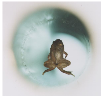
Figur 1: En levende frosk som leviterer i et sterkt magnetfelt (ca. 16 Tesla). (Nijmegen High Field Magnet Laboratory [ http://www.hfml.ru.nl/froglev.html ])
