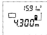
Mål deretter lengde og bredde etter hverandre som for en lengdemåling. Mellom de to målingene forblir laserstrålen innkoblet.
