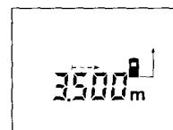
Trykk måle-tasten **8** til utløsing av målingen. Beveg måleapparatet helt til ønsket avstandsverdi anvises i nede på displayet.
