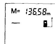
Trykk på minne-tasten **10** for å anvise verdien i minnet. På displayet vises «M=». Når minneinnholdet «M=» anvises på displayet, kan du fordoble den ved å trykke på minne-addisjonstasten **3** hhv. nullstille den ved å trykke på minne-subtraksjonstasten **2**.
