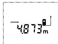
Trykk en gang på måletasten **8** til sikting og en gang til til måling.
