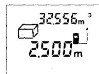
Deretter måles lengde, bredde og høyde etter hverandre som ved en lengdemåling. Mellom de tre målingene forblir laserstrålen innkoblet.
