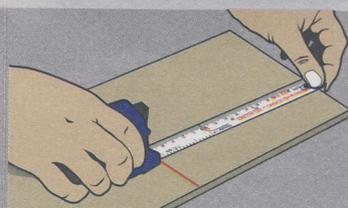
**(S)** LÅNGDÖVERFÖRING Passa in de kombinerade märk- och mät-eggarna över mätpunkterna på samma sätt som med ett skjutmått, eller ställ in längden på skalan mot avläsningsvisarna och läs sedan skalan. Använd sedan märkeggarna för att ritsa den låsta längden på arbetsstycket.
