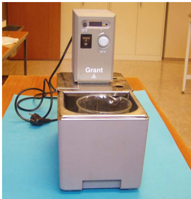
Fig. 1 Utstyr for termostatstyrt vannbad
