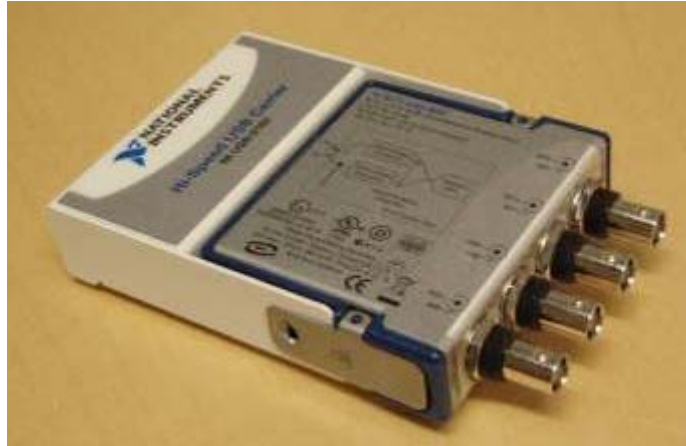
Fig. 1. Analog til digital omformer med USB-tilkopling til PC
