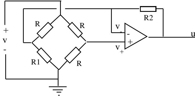
$v_+$  er en enkel spenningsdeling av  $V$  gjennom to like motatander  $R$ , og må ligge konstant på  $V/2$ .  $v_-$  må være lik  $v_+$  (ideell op-amp.), altså
