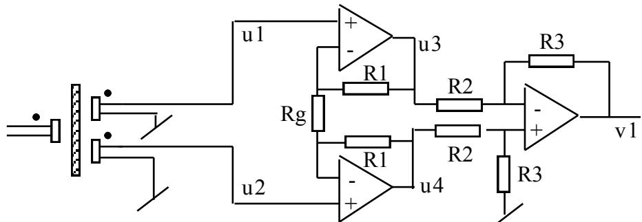
En instrumenteringsforsterker forsterker differensen mellom inngangssignalene.
