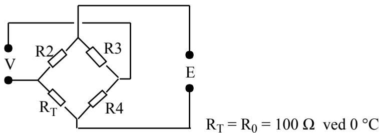
Dimensjonering : Balanse, dvs.  $E = 0$  ved  $0 \text{ } ^\circ\text{C}$  krever at  $R_3 / R_2 = R_4 / R_0$ .
