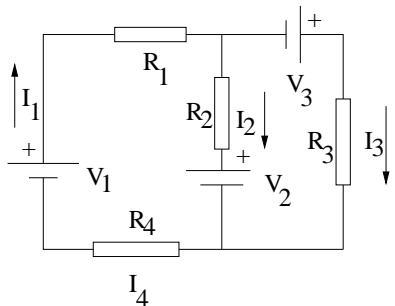
Figuren viser en elektrisk krets. Den består av tre ideelle batterier med EMS'er på hhv.  $V_1$ ,  $V_2$  og  $V_3$ , og fire motstander med resistanser hhv.  $R_1$ ,  $R_2$ ,  $R_3$  og  $R_4$ . I kretsens forskjellige grener går strømmene  $I_1$ ,  $I_2$ ,  $I_3$  og  $I_4$ .
