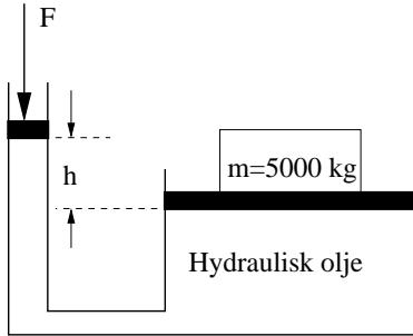
Den venstre cylinderen har et tverrsnitt  $A_V = 0,0100 \text{ m}^2$ , og den høyre cylinderen har et tverrsnitt  $A_H = 2,00 \text{ m}^2$ . Det står en container med masse  $m = 5000 \text{ kg}$  på jekkens høyre cylinder. Anta først at kraften  $F$  som presser nedover mot det venstre stemplet er null. Stemplenes masse er så liten at de kan neglisjeres.
