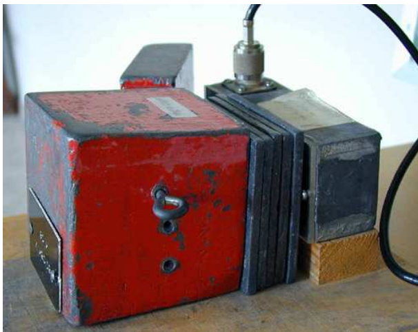
Figur 2: Blykammer til venstre, med blyplater foran GM-røret. GM-røret er skjult inne i kammeret lengst til høyre på bildet.
