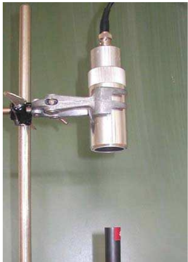
Figur 3: GM-rør med tynt endevindu (nedre ende) montert over en \gamma -kilde. Denne oppstillingen benyttes i oppgavene 2 (uten kilde) og 3 (med kilde).
