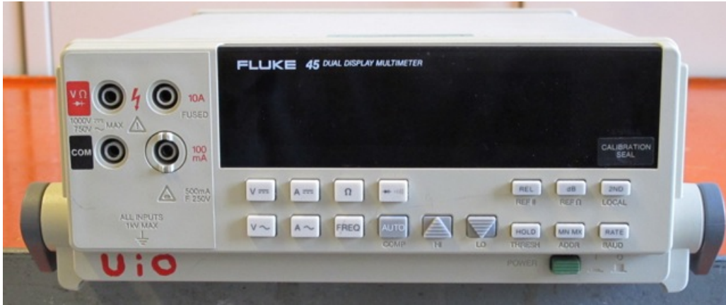
Figur 1: Frontpanelet av multimeteret Fluke45.
