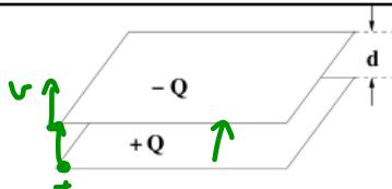
Figuren viser to parallelle metallplater med areal  $A = 0,5 \text{ m}^2$  i en avstand  $d = 2 \text{ cm}$ . Platene lades opp slik at potensialet mellom dem er  $V = 4000 \text{ volt}$ .  $= U$
