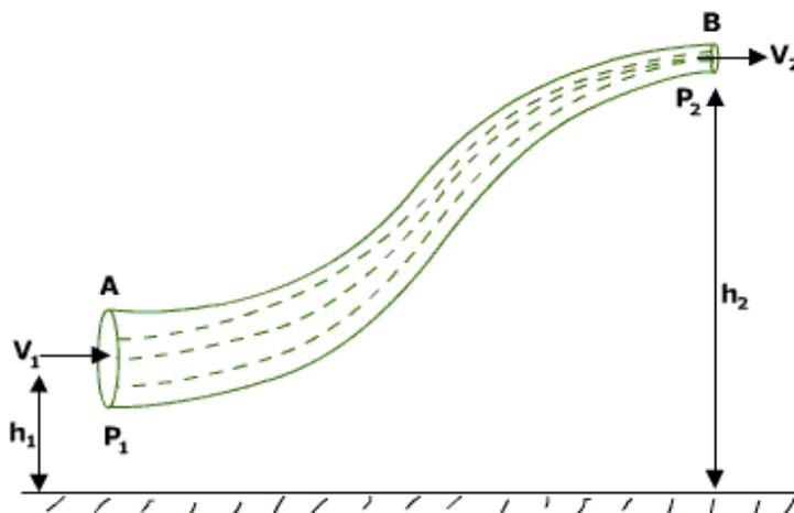
I røret strømmer det vann, og vi får oppgitt at  $h_1 = 0,75$  m,  $v_1 = 5,0$  m/s,  $p_1 = 223$  kPa og  $p_2 = 145$  kPa. Ved A er tverrsnittet  $4,0$  cm<sup>2</sup> og ved B er det  $2,0$  cm<sup>2</sup>. Hvor stor er høyden  $h_2$ ?
