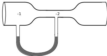
Et hult sylinderisk rør med radius  $r_1 = 2.0$  cm har en innsnevring på midten slik at radiusen ved midten av røret er  $r_2 = 0.75$  cm. Til røret er det koblet en slange som er delvis fyllt med vann med massetetthet  $1000 \text{ kg/m}^3$ .
