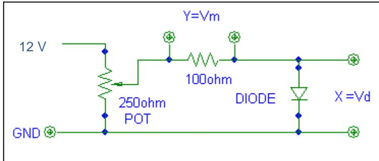
Kretsen er ferdig montert på et brett med fast power supply på 12 V. Vi koplet et multimeter over motstanden på  $100\ \Omega$  og måler  $V_m$ . Et annet multimeter koples over dioden og måler diodespenningen  $V_d$ . Inngangspenningen justeres med potensiometeret slik at spenningen over dioden ( $V_d$ ) varierer fra 0,4 V til 0,75 V. Strømmen i dioden finner vi ved å måle spenningen over motstanden ( $V_m$ ) som står i serie med dioden, og så beregne strømmen.
