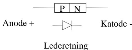
Når man skal anvende en diode, må man vite hvilken ledning som tilsvarer anoden og hvilken som går til katoden. Dioder er ofte merket med en ring eller fargeflekk ved katoden.
