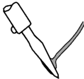
Figur 19 Etter at loddebolten er rengjort, fortinnes begge sider med litt tinn.
