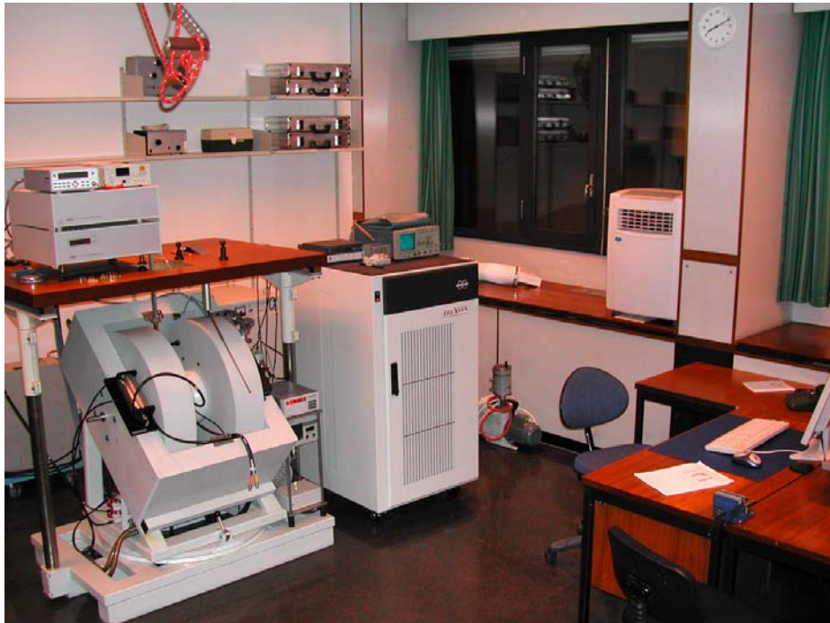
Bruker EleXsyS SuperX X- og Q-bånd EPR spektrometer fra 2005
