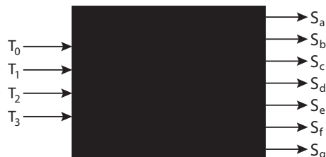
Figur 2.3: En «black box» for logikk og styring av en 7-segment skjerm hvor inngangen er en 4-bits binært tall og hvor (S_a, S_b, S_c, S_d, S_e, S_f, S_g) referer til lysdiodene.
