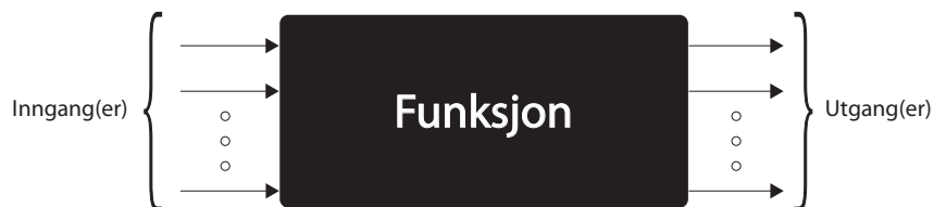
Figur 2.1: Et klassisk utgangspunkt for å designe en krets. Man starter med å tenke at en krets er en boks som skal utføre en funksjon og har et sett av inngang(er) og utgang(er).
