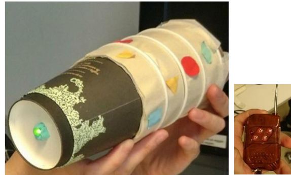
Nr.6: CupQuiz med Led-lys, og innebygd piezo. Styrt av en fjernkontroll for å avgi rødt eller grønt-lys.
