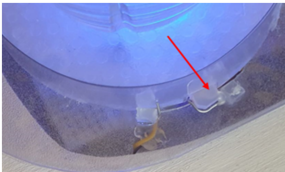
Bilde 4.3: Tre slike plastblokker er festet rundt kaffebeholderen for å holde platen stabil .
