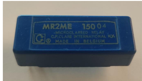
Figur 9: Nær bilde (overside) av reed-switch-typen som ble brukt til å endre status. Under er det flere pins på hver side.
