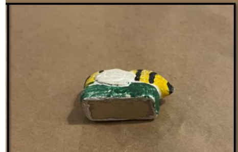
Figur 5: Biemagneten som brukes for å endre status og som fullfører kretsen til Reed-switchene
