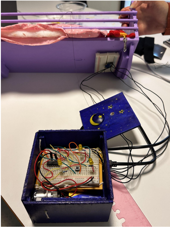
Figur 6: Sensoren sitter på et breadboard limt på undersiden av vuggesengen. Sensoren kobles til Arduino gjennom wire. For å skjule wire brukte vi en type "sleeve".
