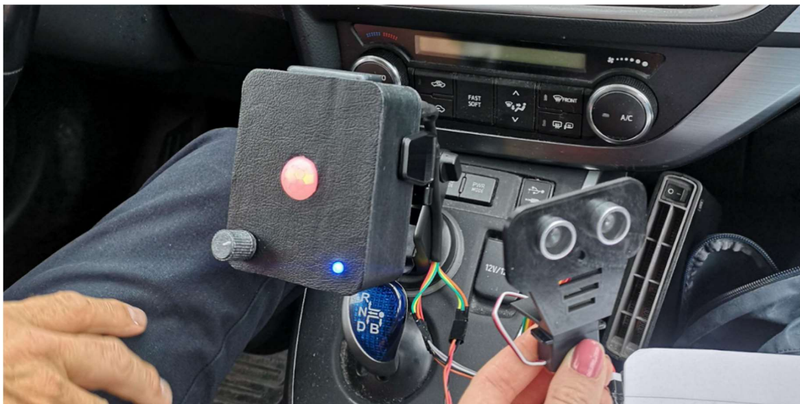
Figur 30: Varslinsenheten på display og montert i bil. Viser med radar og servo koblet til med varsling aktivert
