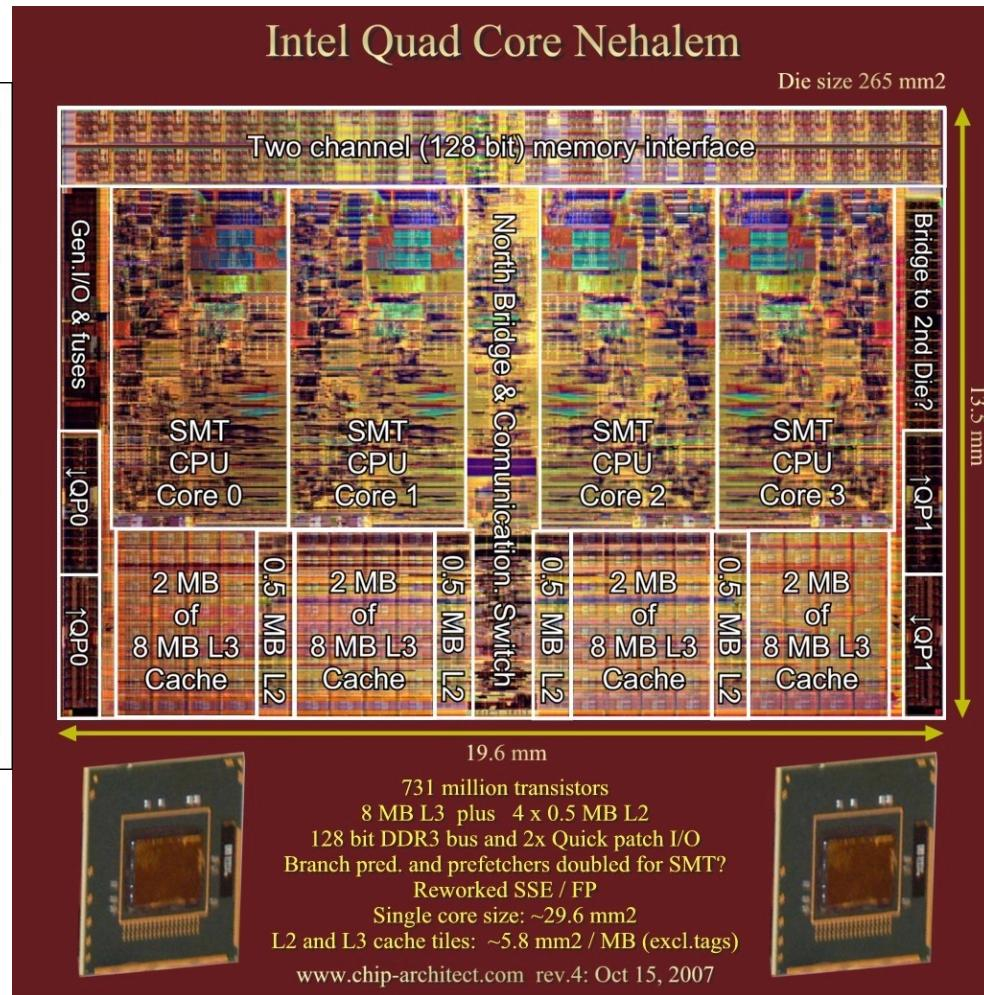
Mange ulike deler i en Multicore CPU – bla. en pipeline av maskininstruksjoner; kjernene holder på med 10 til 20 instruksjoner **samtidig** dvs. instruksjonsparallelitet
